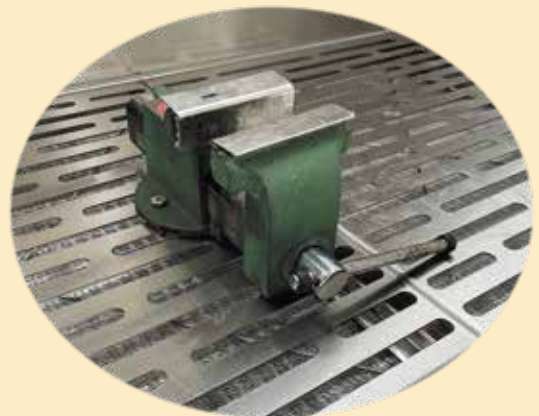
工作檯面可固定夾床、夾具等工具
